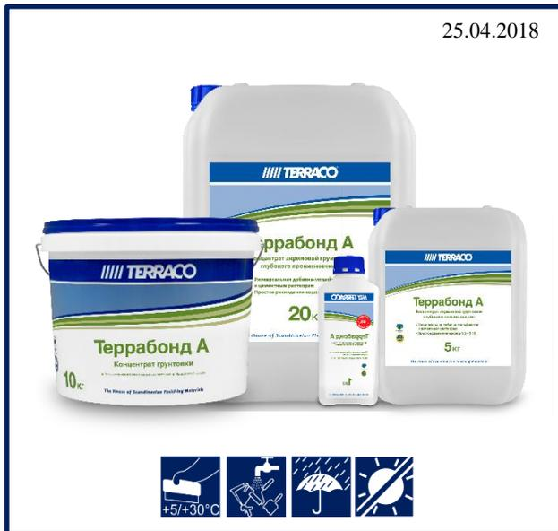
При приготовлении штукатурных растворов: добавление Террабонд А увеличивает адгезию, улучшает прочность на изгиб и удобоукладываемость смеси на бетонные поверхности. Для затворения рабочей смеси использовать раствор с водой в пропорции 1:7
